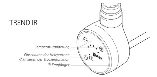
Das Einschalten der Heizpatrone mit der Taste O verursacht, dass der Heizkörper bis zur gewünschten Temperatur aufheizt. Sobald diese erreicht wird, wird sich das Gerät zeitweise Ein- und Ausschalten um die eingestellte Temperatur einzuhalten.
