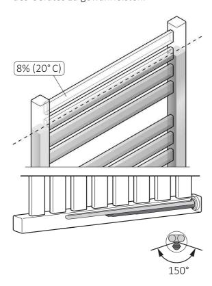
Bei der horizontalen Montage einer Heizpatrone sollte sich das einzelne Rohr mit dem Sensor an der niedrigstmöglichen Stelle befinden.
