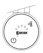
Eine einzelne Diode RGB leuchtet rot. Nach Ablauf der eingestellten Zeit kehrt die Heizpatrone automatisch zu den Einstellungen vor Aktivierung dieser Funktion zurück. Bei aktivierter TIMER-Funktion kann die Heiztemperatur frei geändert werden (Taste 11). Sollte das Gerät vor dem Starten der TIMER-Funktion ausgeschaltet gewesen sein, schaltet es sich nach Ablauf der Zeit automatisch wieder aus.
