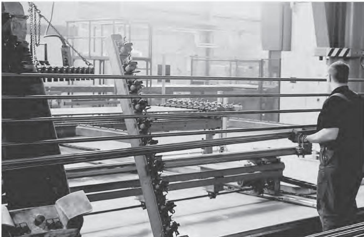
Als anschlussfertige Einzelelemente werden die Deckenstrahlplatten bis maximal 6 m Gesamtlänge werkseitig gefertigt. Bänder über 6 m Länge werden bauseits aus mehreren Deckenstrahlplatten durch Aneinanderschweißen oder mit Spezialpressfittings verbunden.
